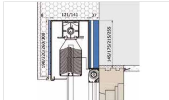
Mit Wärmedämmverbundsystem und Sturzdämmung
