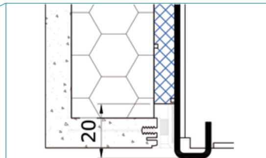
Sonderausführung für Wärmedämmverbundsystem
