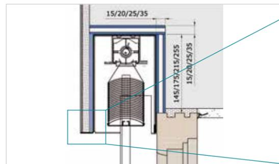
Mit Sturzaussparung und Sturzdämmung
