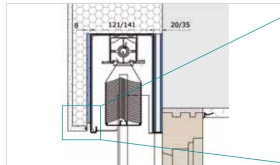
Mit Wärmedämmverbundsystem und Sturzdämmung
